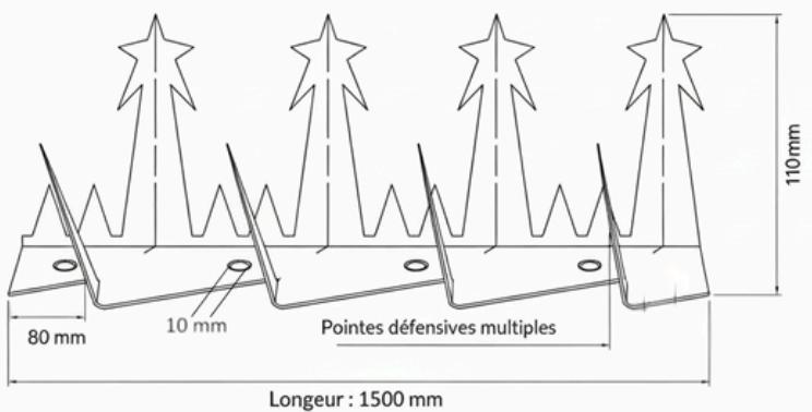
**Recommandation d'usage :** Anti franchissement, protection de mur (dessus ou en applique), protection d'acrotère ou d'accès terrasse, protection dessus de portail pivotant, protection poteau.
