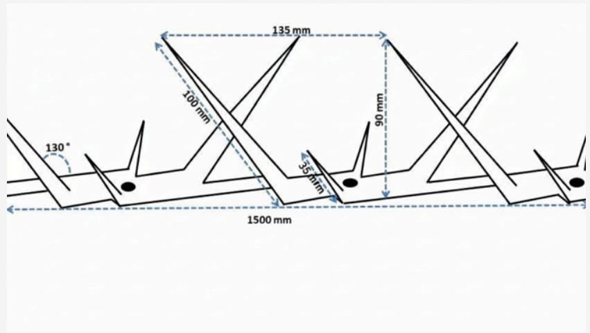
**Recommandation d'usage :** Anti franchissement, protection de mur (dessus ou en applique), protection d'acrotère ou d'accès terrasse, protection dessus de portail pivotant, protection poteau.
