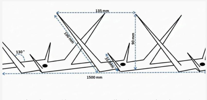
**Recommandation d'usage :** Anti franchissement, protection de mur (dessus ou en applique), protection d'acrotère ou d'accès terrasse, protection dessus de portail pivotant, protection poteau.
